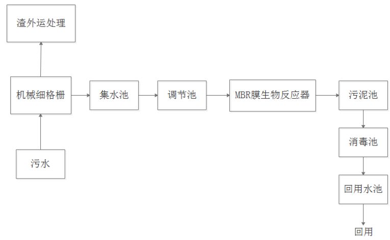
图 4.1-11 业主营地 MBR 一体化污水处理工艺流程图
